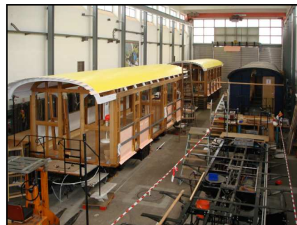
Die beiden Wagen im Rohbau
