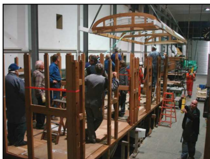
Das Dach des B 2206 schwebt ein, um auf die Träger des Kastens aufgesetzt zu werden
